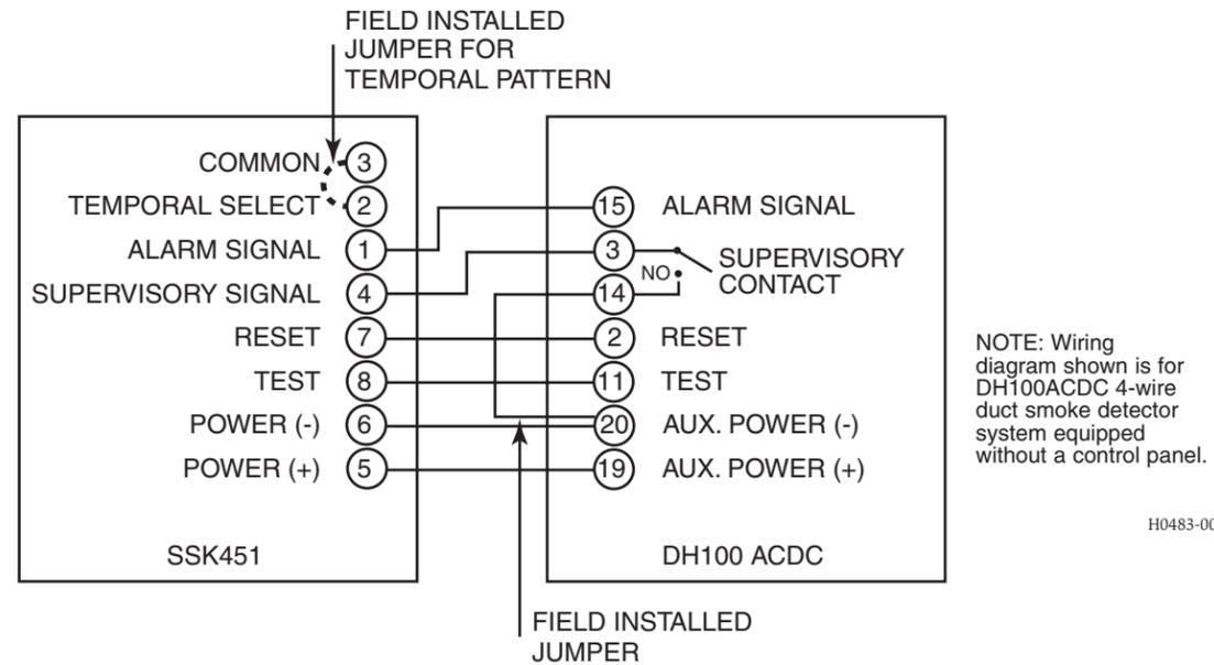
**Figure 2. SSK451 with DH400ACDC Duct Smoke Detector:**
